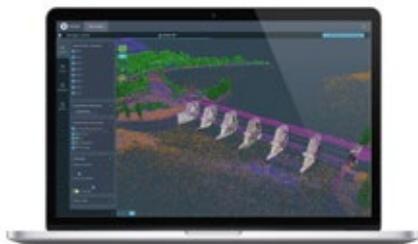
Scanner une structure au moyen d'un capteur numérique, à distance ou de manière rapprochée, afin de détecter la présence de désordres et porter un jugement sur l'état de conservation de l'ouvrage.
