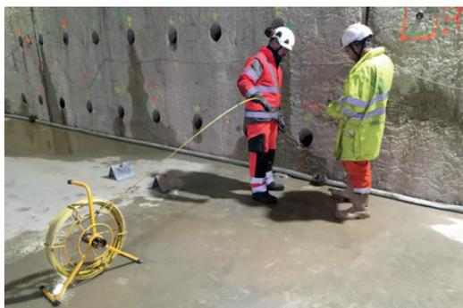
La **sonde gyroscopique** permet la **mesure de déviations de forages**, quelle que soit leur inclinaison de l'horizontale à la verticale et quelle que soit leur profondeur.
