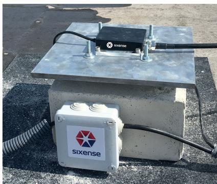
Le capteur 4DBloc a été développé et testé en coopération avec l'IGN (Institut National de l'Information Géographique et Forestière, l'ancien Institut Géographique National) avec l'objectif d'obtenir un **système de mesure de position par GNSS** qui soit robuste, simple, autonome et précis.
